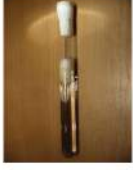
Reagenzglas mit Wassertank
