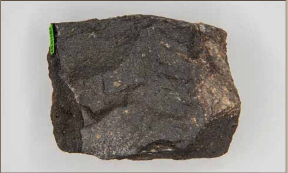
Abb. 7: Durch den sehr hohen Anteil an Amphibolmineralen (Hornblende) hat dieser Andesit aus dem Siebengebirge eine sehr dunkle, fast schwarze Färbung. Er sieht einem Basalt, wie zum Beispiel den aufgestellten Säulen im Kromlauer Park, zum Verwechseln ähnlich! (Hornblendeandesit, Siebengebirge, Deutschland; SNSD Petrographie Inv.-Nr. AS 201167; Bildbreite: 10 cm)
