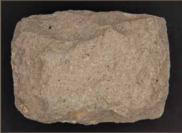
Abb. 4: Dieser hellgraue Andesit ist relativ dicht. Das bedeutet, die einzelnen Minerale im Gestein sind kaum zu erkennen: Das Gestein wirkt wie eine einheitliche feine Masse, die an Brei erinnert.
