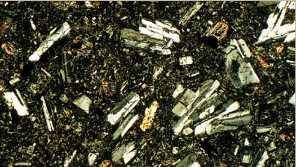
Abb. 6: Unter dem Mikroskop mit gekreuzt polarisiertem Licht zeigt sich das porphyrische Gefüge des Andesitgesteins sehr deutlich: In einer feinen, dunklen Grundmasse schwimmen größere Kristalle. Diese Kristalle heißen Einsprenglinge: Hell oder grau sind Einsprenglinge von einem Feldspatmineral, bräunlich und in Regenbogenfarben schillernd sind Einsprenglinge von einem Glimmermineral. (Bildbreite: 3,4 mm)
