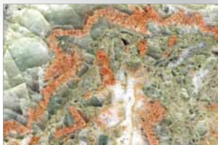
Ryc. 5: Jasnozielony fluoryt z cielistym skałeniem potażu (paradoksyt) i białym kwarcem gangu, wypolerowana rękojeść, złożę rzeki Schönbrunn w Vogtland (Saksonia), (szerokość obrazu 6,5 cm),
